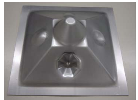
Bild 3 Hämmernd umgeformtes Aluminium- blech mit Hinterschnitt.
