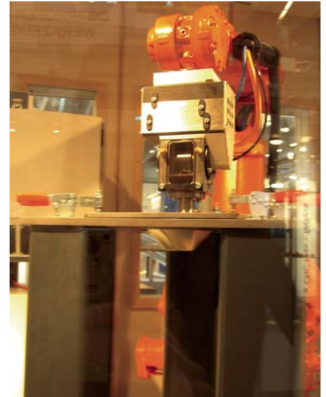
Bild 1 Roboterzelle zur matrizenfreien, hämmernden Blechumformung.
